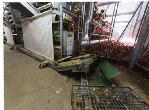
Rondom de middenkern voeren mestbanden de voorgedroogde mest uit het Bolegg Terrace-voliëresysteem af
