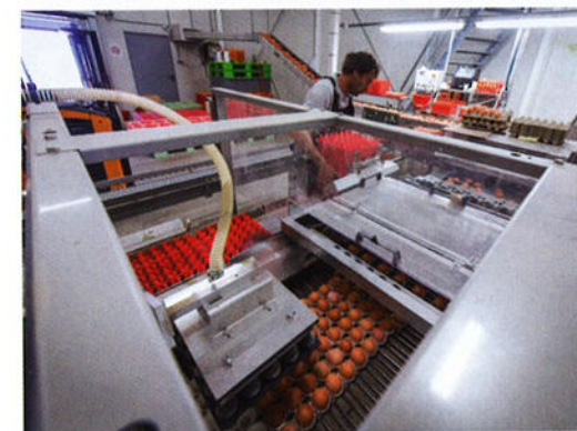
In de middenkern staat een Prinzen Smartpack met een bruto capaciteit van 36.000 eieren per uur
